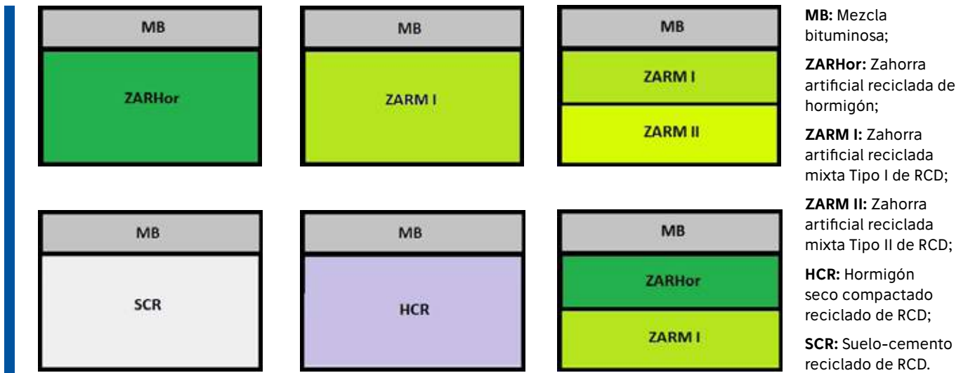
ILUSTRACIÓN 2. TIPOS DE SECCIONES ESTRUCTURALES RECOMENDADAS PARA EL USO DE ÁRIDOS DE RCD
